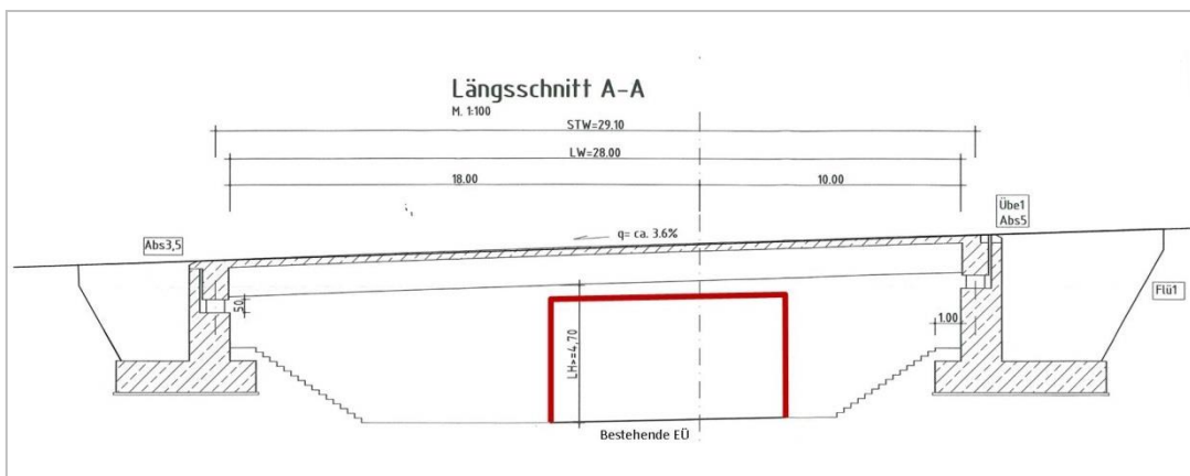
Abbildung 10 Bauwerksplan Landesbetrieb Straßenbau EÜ B8n
